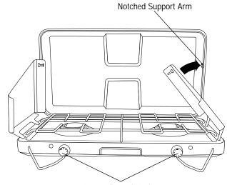
**Burner Control Knobs**
